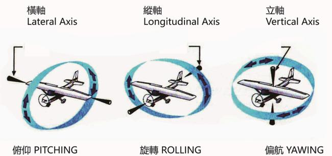
為了更好地理解飛行姿態的由來，我們假象飛機有三個虛擬的軸，它們分別是橫軸、縱軸和立軸。飛機圍繞橫軸可以做俯仰運動，圍繞縱軸可以做滾轉運動，圍繞立軸可以做偏航運動。
